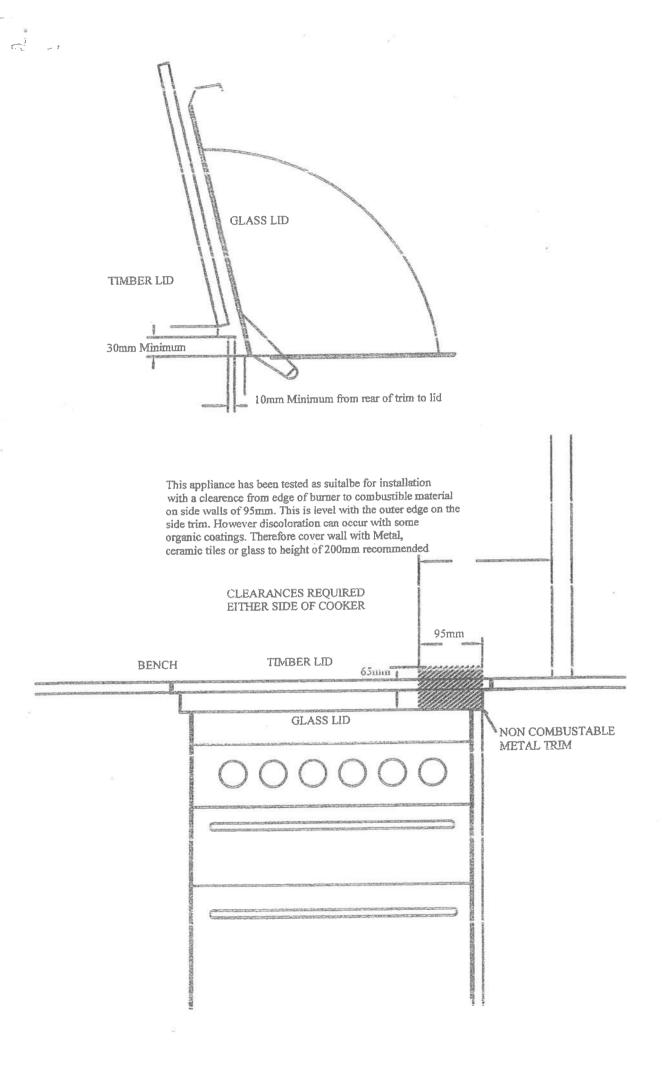
MINIMUM HEIGHT TO OVERHEAD CUPBOARDS 600mm OR 400mm FROM BENCH TOP TO UNDER SIDE OF SWIFT RANGE HOOD
