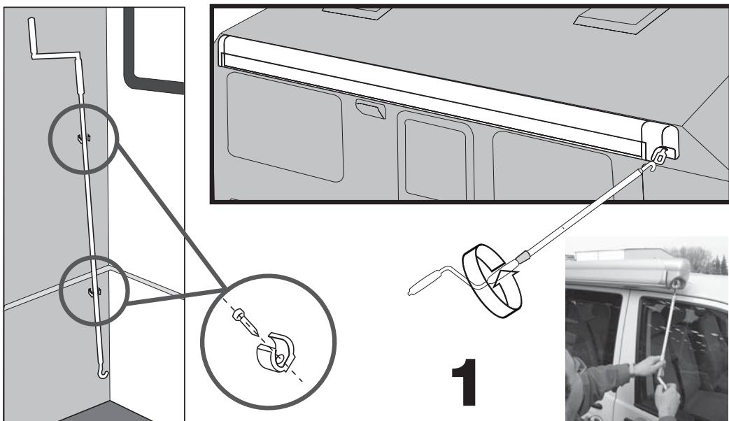
**DE** Um die Markise, aber vor allem die Fahrzeugwand, nicht sinnlos zu belasten, müssen - nach ungefähr 1 m Auszug - die Stützbeine auf den Boden gesetzt werden.
